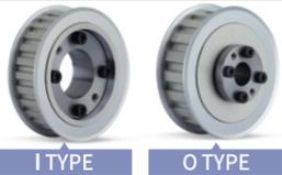
**锁紧原理** 通过紧固锁紧螺栓，使锥形衬套外部与同步带轮内部产生楔子现象，由锥形衬套内部收缩紧固轴的方式。
