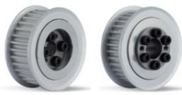
**锁紧原理** 通过紧固锁紧螺栓，使胀紧套内轮与外轮的楔子形状，实现内侧紧固轴的同时外侧通过膨胀紧固同步带轮。
